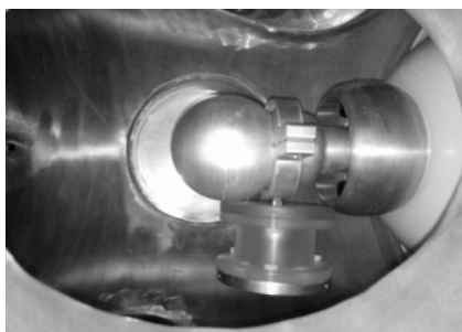
图7 放电模型安装示意图
